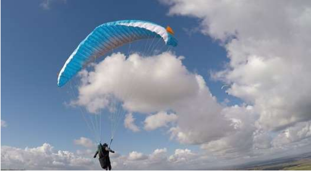
Şekil 8. Arışı fren uygulamak yüzünden Derin Stol olmuş bir kanat.
