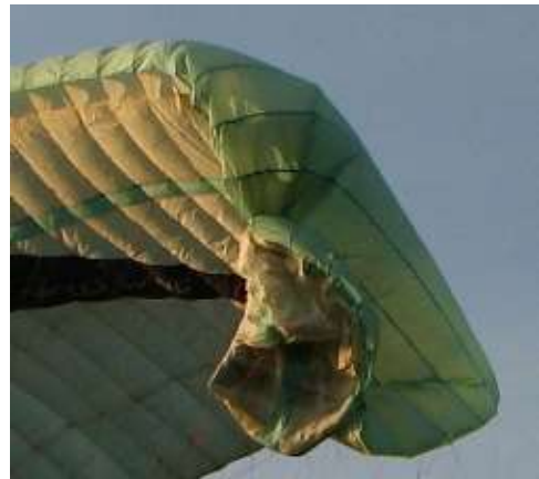
Şekil 3. Kalkış esnasında kravat olmuş bir kanat.
