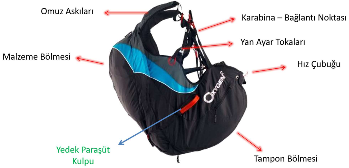
Şekil 20. Kuşam Tertibatının Yandan Görünüşü
