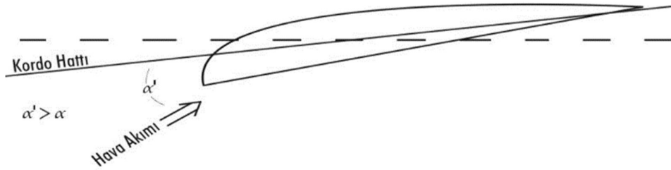
Şekil 9. Düşük Hücum Açısı
